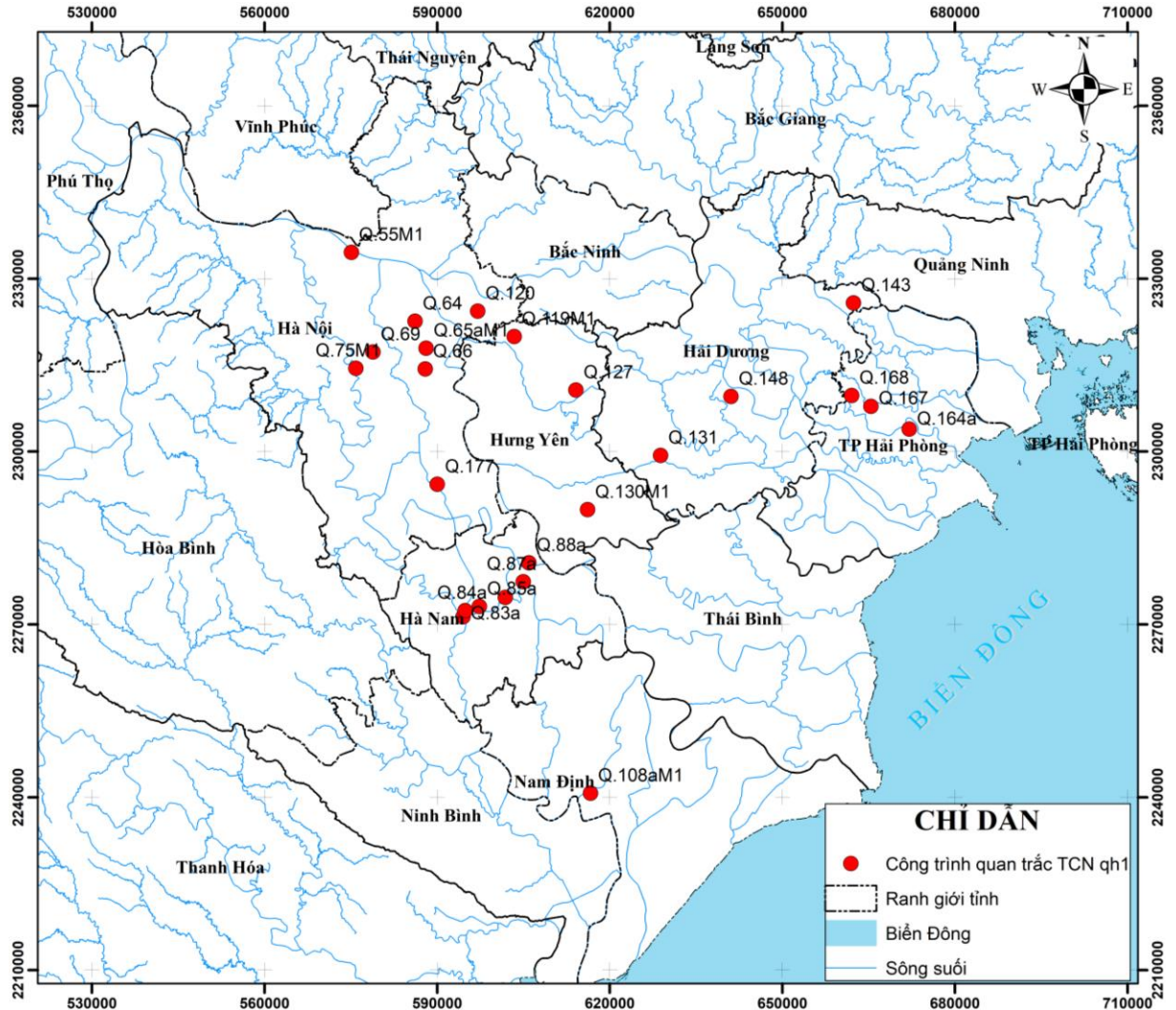
Hình. 6. Bản đồ bố trí công trình quan trắc lớp chứa nước lỗ hổng trong trầm tích Holocen dưới ( qh_1 ) vùng đồng bằng Bắc Bộ
